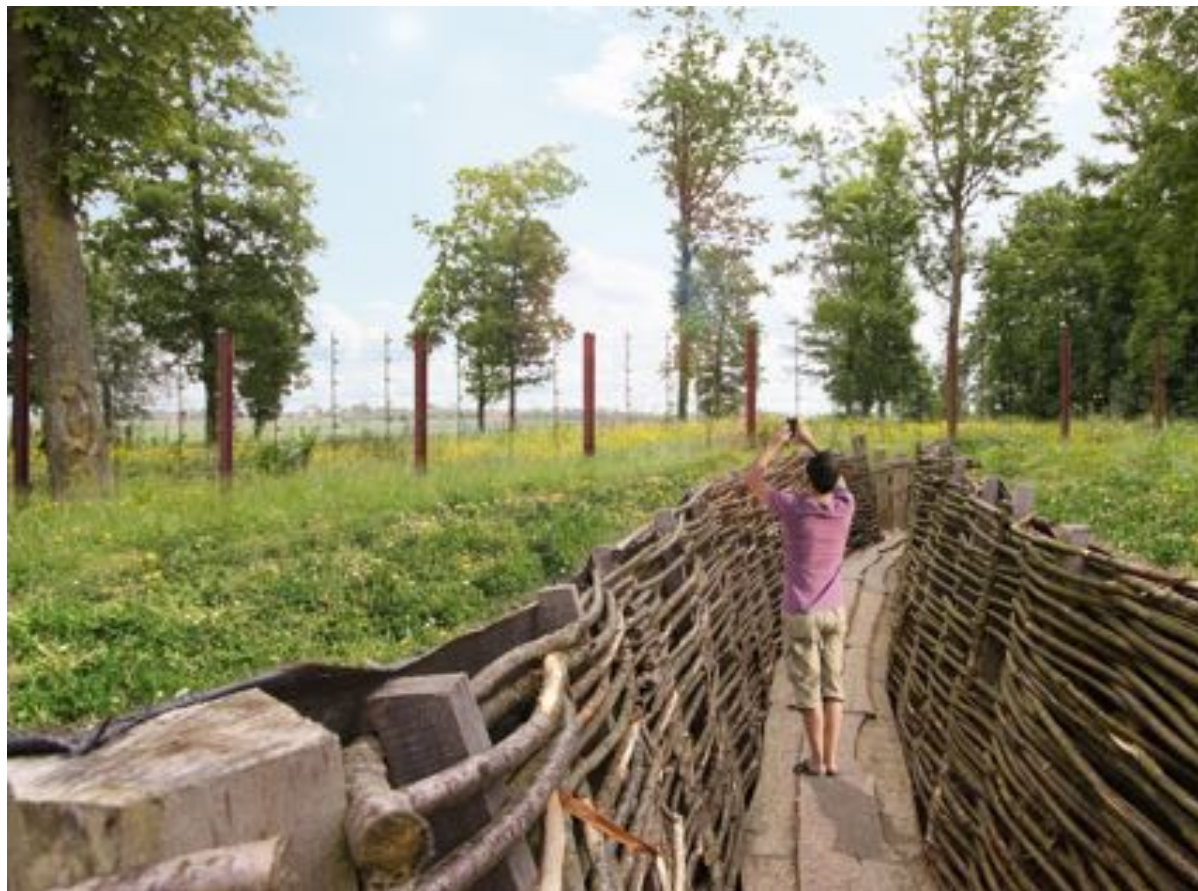
Figuur 76 - Visualisatie (conceptvorming) van een transparante omheining, met metalen H-profielen, kabels en de typische schroefpiketten met lussen (buro voor vrije ruimte)
