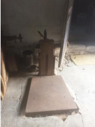
Figuur 3.59. molenbascule. Deze diende vroeger regelmatig geijkt te worden door het Ministerie van Economische zaken.
