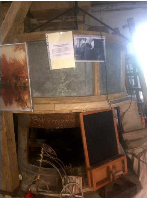
Figuur 3.53: moutsteenkoppel: dit steenkoppel, gemonteerd op een betonnen sokkel, werd tweedehands aangekocht rond 1945 en is afkomstig van een cichoreibranderij in Hekelgem. Het diende nog een dertigtal jaren voor het malen van mout (gekiemde en gedroogde gerst), bestemd voor de brouwerij De Troch. Aandrijving door de centraal opgestelde elektromotor. Momenteel niet operationeel.
