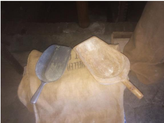
Figuur 3.67. houten en metalen meelschep. Tot begin de jaren '80 werden ze nog frequent in de molen gebruikt, nu nog enkele keren per maand.
