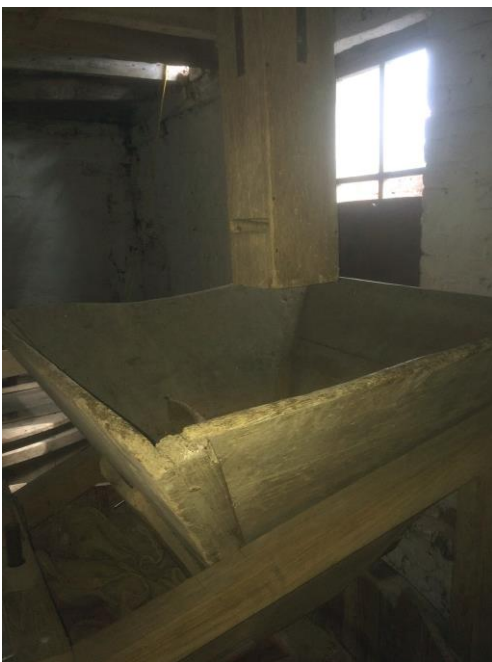
Figuur 3.46. kaar of graanbak, waarin het graan gestort wordt dat bestemd is om door het betreffende steenkoppel te worden gemalen. Via de schuddenbak wordt het graan uit de kaar geschud, waardoor het tussen de loper en de ligger terecht kan komen terwijl de loper draait.
