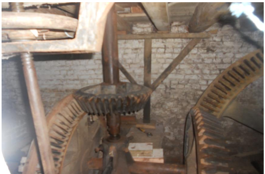
Figuur 3.40.a+b: het conisch tandwiel vormt de derde trap in het versnellen van het aantal omwentelingen vanaf het watterrad tot de maalsteen en wordt aangedreven door de lijnas. Dit tandwiel is gemonteerd op de verticale aandrijfas of peerijzer. Het peerijzer drijft de bovenste maalsteen of looper aan. Het watterrad draait normaal aan 10 à 12 omwentelingen per minuut, de looper draait 4,5 maal sneller: tussen de 45 en 55 toeren per minuut.
