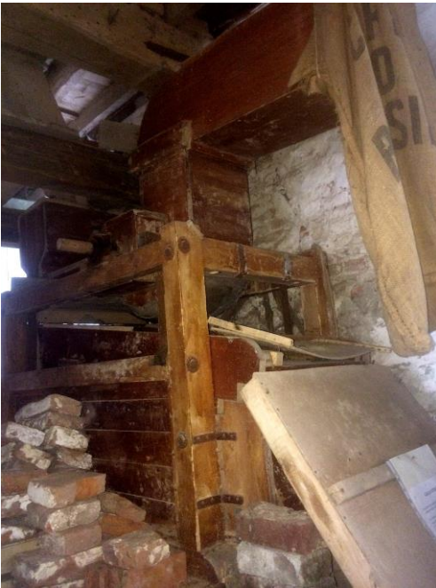
Figuur 3.52.c: eveneens de graantrieur. Deze werd aangedreven door de centraal opgestelde elektromotor en diende voor het schoon maken van zaaigraan. Voorlopig niet operationeel.
