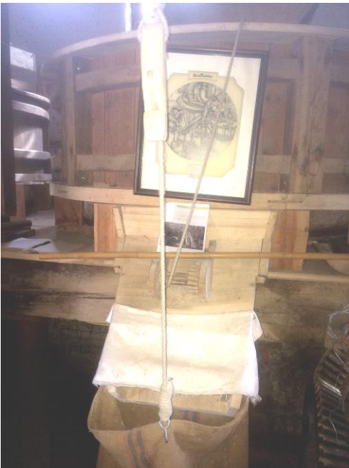
Figuur 3.44. het nog maalvaardige steenkoppel met houten steenkist. Rechtsonder op de foto, dwars op de lijnas, het middelste aandrijf wiel (voor de overbrenging van het molenwiel op de lijnas) dat nog operationeel is.
