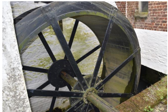
Figuur 3.17.a en 3.17.b: Het ijzeren bovenslagrad met bouten en klinknagels, heeft een diameter van ongeveer 3,50 m. De wateras is in ijzer met gietijzeren lagerblokken.
