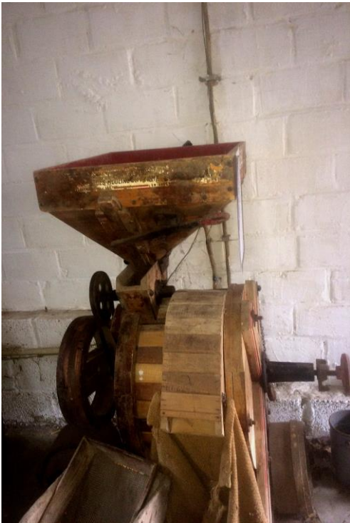
Figuur 3.55.a+b.: DDD-molen: 2 verticaal opgestelde kleine maalstenen, apart aangedreven door een elektromotor. Voorlopig niet operationeel.
