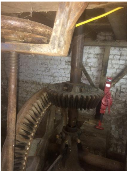
Figuur 3.40.a+b: het conisch tandwiel vormt de derde trap in het versnellen van het aantal omwentelingen vanaf het watterrad tot de maalsteen en wordt aangedreven door de lijnas. Dit tandwiel is gemonteerd op de verticale aandrijfas of peerijzer. Het peerijzer drijft de bovenste maalsteen of looper aan. Het watterrad draait normaal aan 10 à 12 omwentelingen per minuut, de looper draait 4,5 maal sneller: tussen de 45 en 55 toeren per minuut.
