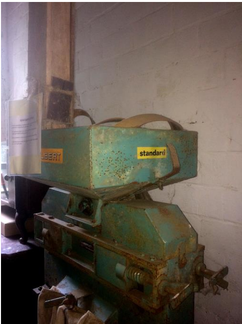
Figuur 3.54. haverpletter, aandrijving door een aparte elektromotor. Bouwjaar rond de jaren 1970. Voorlopig niet draaivaardig.
