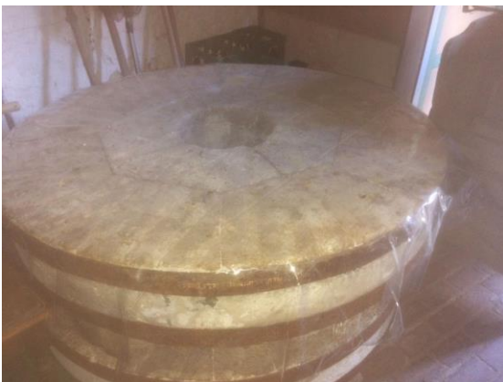
Figuur 3.60. koppel maalstenen uit kwarsiet, afkomstig uit de tarwemolen (=mechanische molen aangedreven door elektromotor) van Sint-Martens-Bodegem, in april 2017 afgebroken. In de Klapscheutmolen zullen ze in principe alleen nog dienen voor demo.
