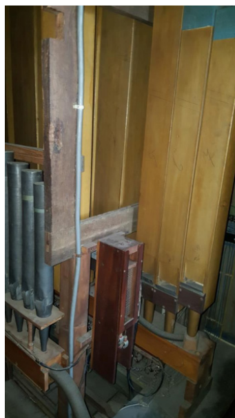
afb. 126: Wellenbord hoofdwerk, aluminiumelementen op een niet duurzame vezelplaat ©G. Schumacher
