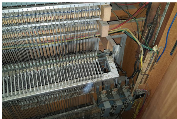
afb. 125: Binnenzicht speeltafel, aluminium tractuur ©G. Schumacher
