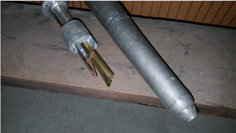
Verdwenen houten spie, verschoven tong en gecorrodeerd stemkruk van een kleine Bombarde 16' pijp
