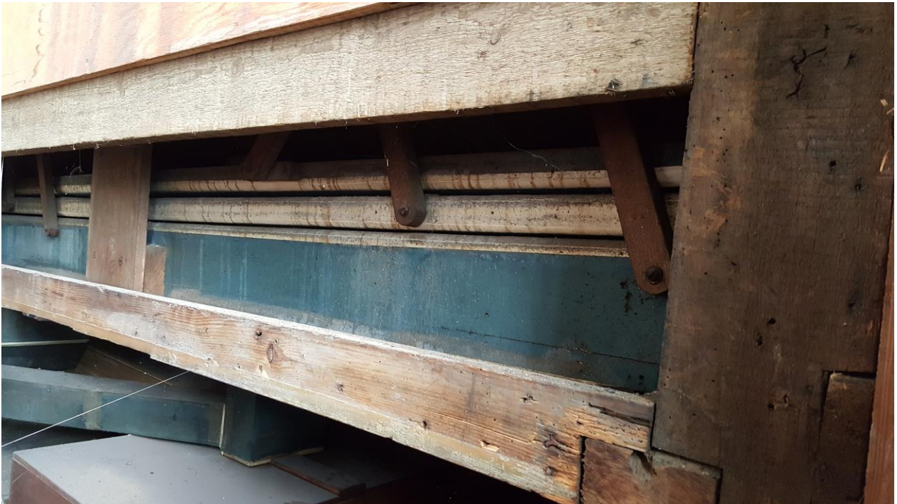
vervuild leder van de magazijn balg
