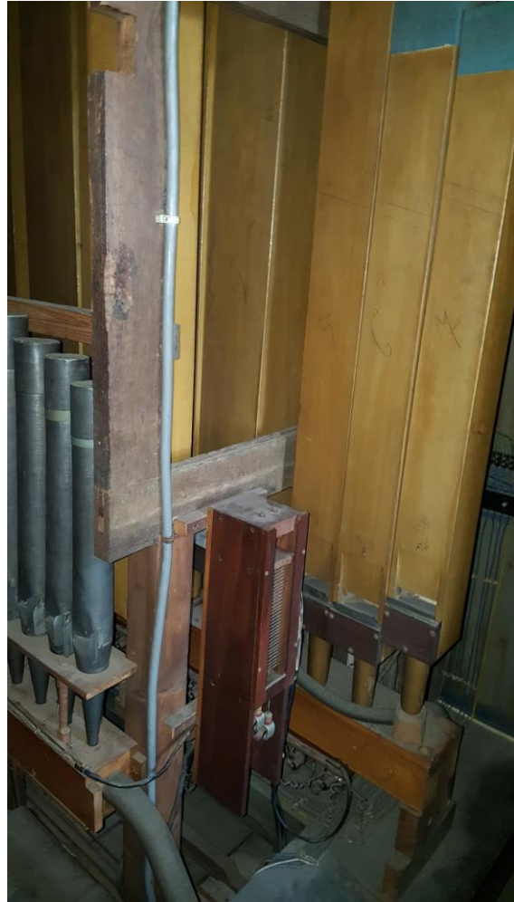
windladen van de Zachtbas 16' pedaal met elektrische tractuur
