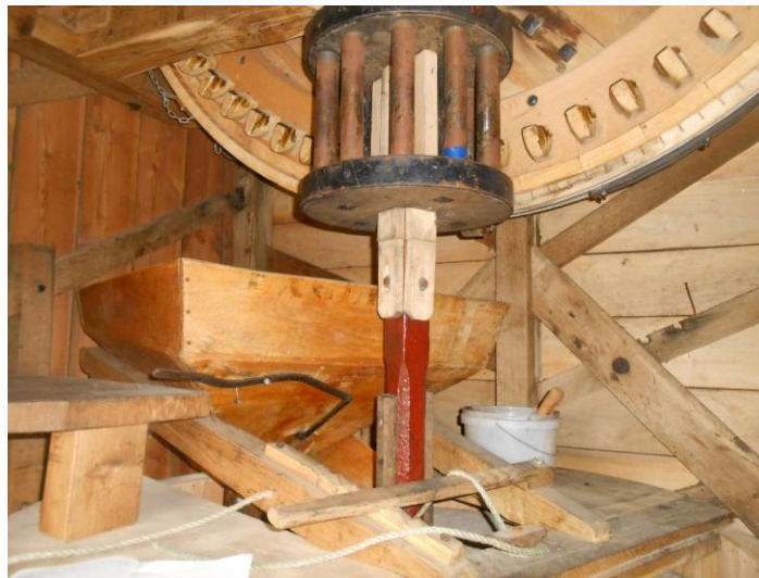
De in het vangwiel inhakende schijfloop ter aandrijving van de maalstoel (© M in O).
