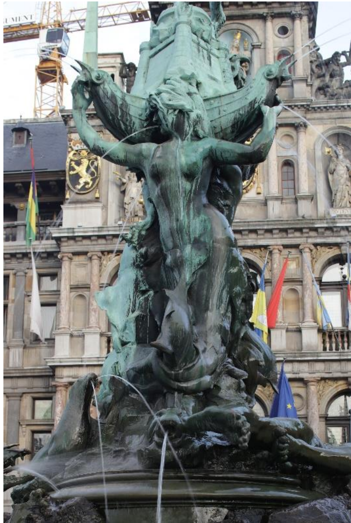
Figuur 37. Patina met diverse schakeringen. De lichtere zones bovenaan worden niet nat door het fonteinwater. Onderaan blijft het brons grotendeels nat. Hierdoor is het geheel donkerder. Op plaatsen waar geen spoeling is door fonteinwater of regen ontstaan zwarte zones.
