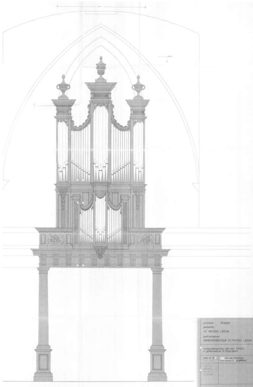
Afbeelding 38. Ontwerp G. Loncke, plan nr. 2. Nieuwe toestand vooraanzicht orgelkast (GASPL, Archief gemeente Sint-Pieters-Leeuw, nr. 66770).
