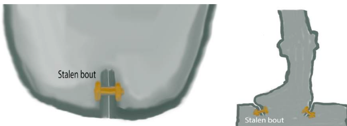
Afbeelding 159. Typische verbinding van twee bronzen onderdelen ("à la romaine") – gezekeerd met behulp van een stalen bout en moer. Schema – Metafose
