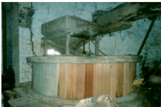
1 steenkoppel tpv mechanische maalderij haverpletter
