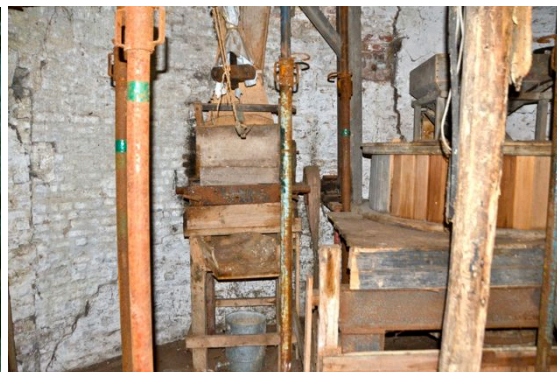
1 steenkoppel tpv mechanische maalderij haverpletter
