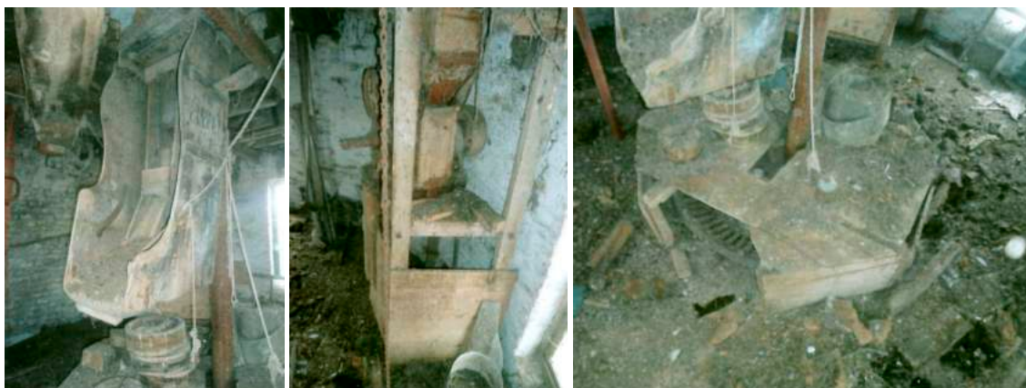
afb. 3.15 © Maarten OSSTYN, het West-Vlaams Molenblad Jaargang 32/1, 2016-1 links ORIGINELE MEELGOOT VOOR EEN VAN DE TWEE STEENKOPPELS midden OUDE HAVERPLETTER rechts OP DE KONING ZIT HELEMAAL ONDERAAN HET EERDER VERNOEMDE WIEL OM DE KOLLERGANG AAN TE DRIJVEN
