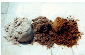
Ingrediënten: bijvoorbeeld om een kleur te verkrijgen: 1 deel luchtkalk of 1 deel scheepkalk, 1 deel zavel, 1 deel rivierzand en 1 deel zilverzand.
