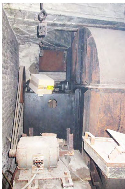
LINKS ELEKTROMOTOR METT DRIJFRIEM
