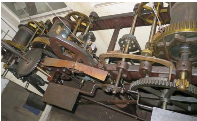
LINKS; DE UURWERKINSTALLATIE GETUIGT VAN ACHTERSTALLIG ONDERHOUD MIDDEN; DE ARMEN VAN DE DENNISONGANG ZIJN MET STUKJES LOOD VERZWAARD RECHTS; VERBINDING MET DE WIJZERWERKEN DIENT TE WORDEN GERESTAUREERD
