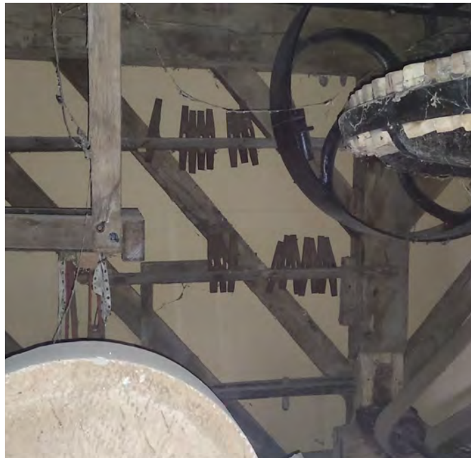
SCHERPHAMERS Op de builzolder zijn een reeks verroeste scherphamers aanwezig.
