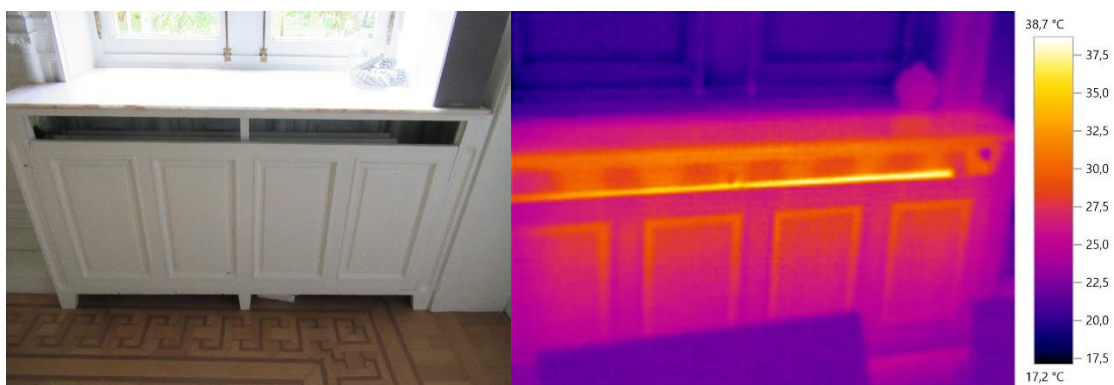
Figuur 23: Radiatoren vervangen door convectoren
