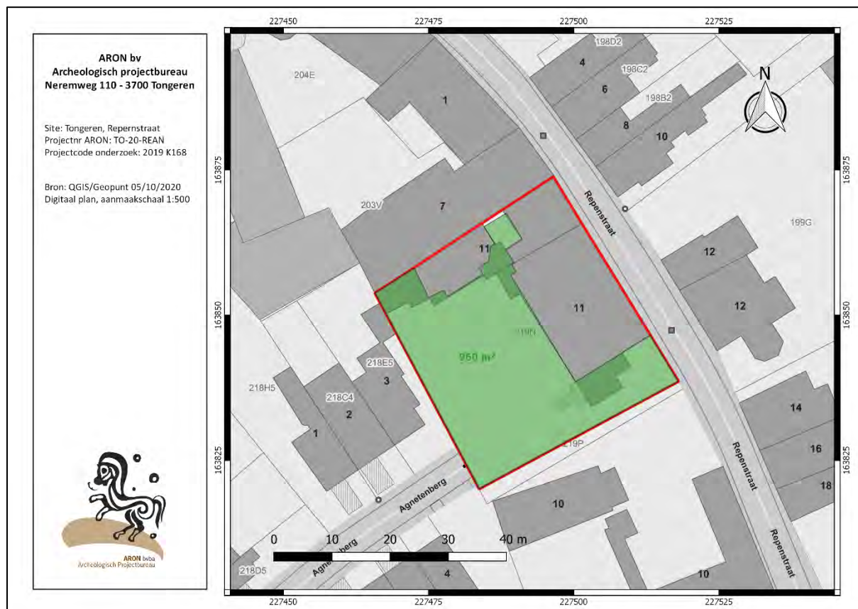
Afb. 47: Kadastraal plan met perceelgrenzen, projectgebied (rood) en afbakening van zone voor werfbegeleiding in het groen. Op de rest van het terrein zullen geen versturende bodemingrepen plaatsvinden en blijft de bestaande structuur (incl. fundering) behouden. De bestaande kelder maakt wel deel uit van de historische bebouwing van het Agnetenklooster en dient fotografisch geregistreerd te worden en alle zichtbare relevante onderdelen ervan onderzocht.
