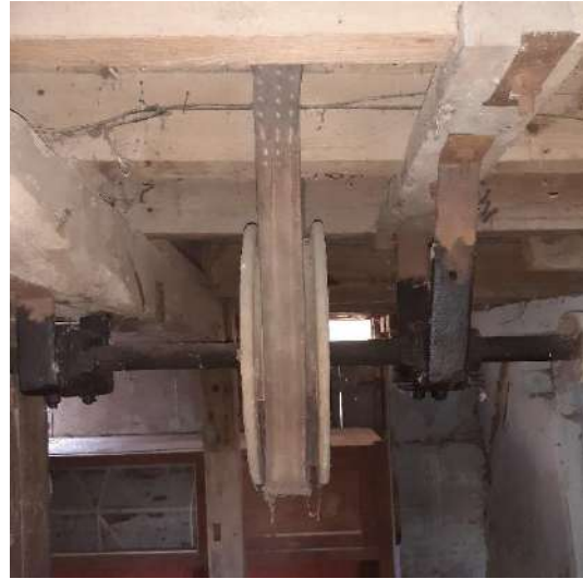
Afb. 141: Riemschijf met leren riem.
