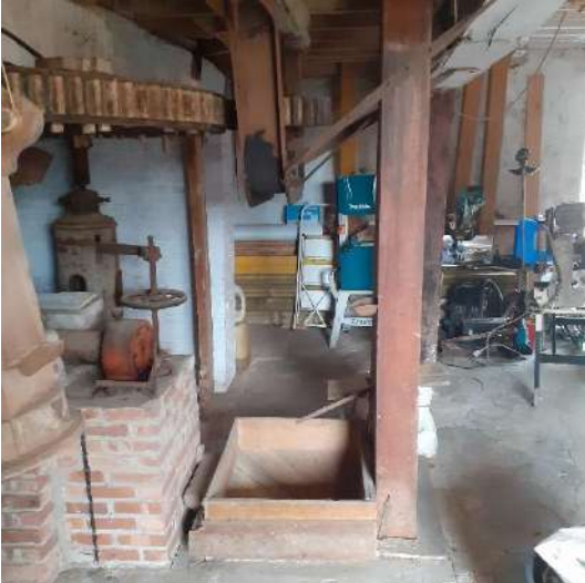
Afb. 131: Jacobsladder voor transport graan naar luizolder met kaar onderaan.
