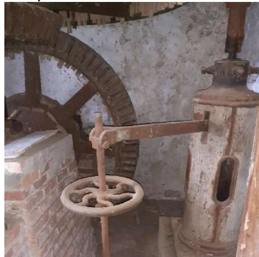
Afb. 130: Gietijzeren onderstel van steenspil met lichtwielmechanisme.
