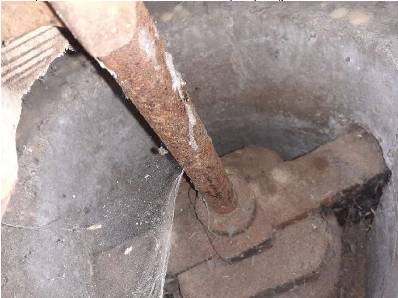
Afb. 135: Detail, aandrijving loper met tweektakse rijnen.
