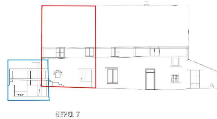
Afb. 6: Aanzicht achtergevel met aanduiding molenhuis (ROOD) en externe moleninstallatie met sluis en damwanden (BLAUW).
