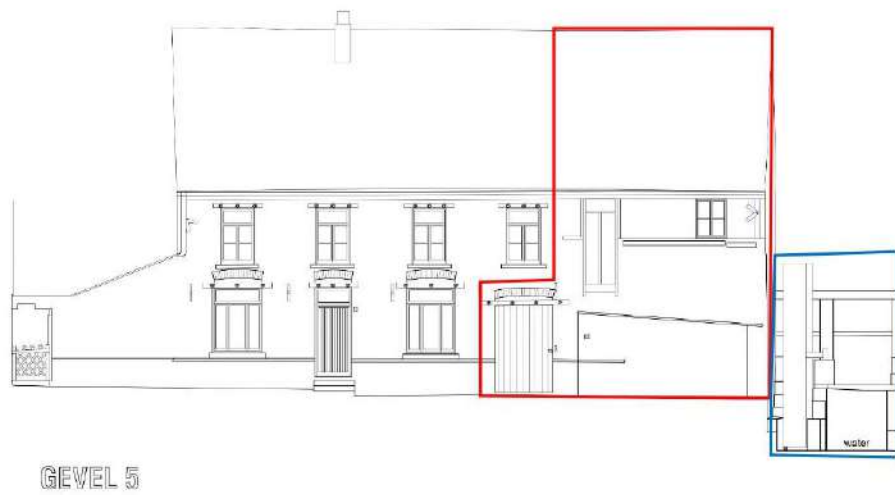
Afb. 5: Aanzicht voorgevel met aanduiding molenhuis (ROOD) en externe moleninstallatie met sluisen en damwanden (BLAUW).
