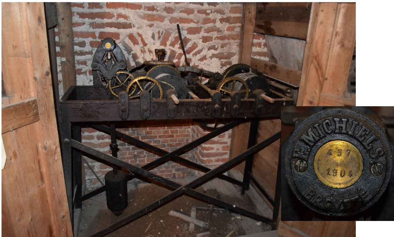
Fig. 186 en 186bis. Elektrisch aangedreven torenuurwerk van Edward Michiels (Mechelen) uit 1904
