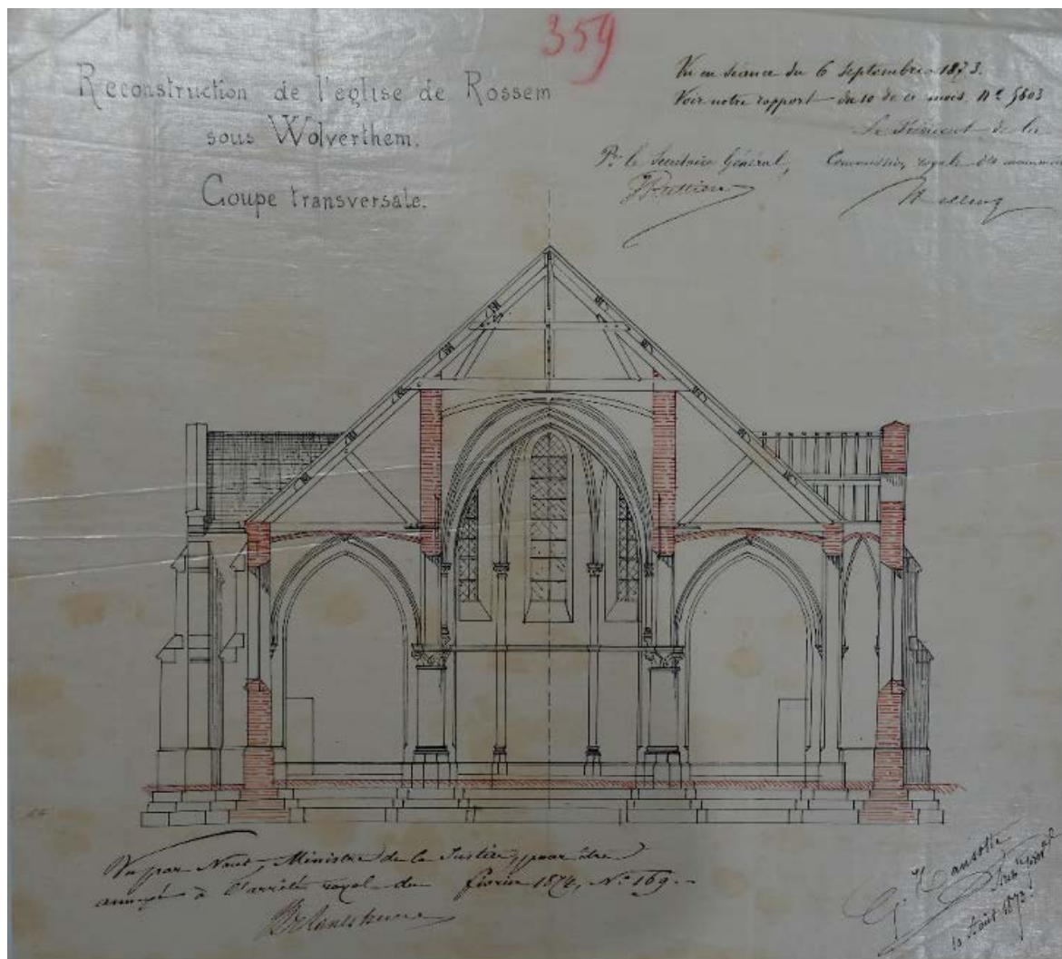
Fig. 45: Plan met dwarsdoorsnede van de kerk naar ontwerp van architect Gustave Hansotte uit 1873 (Onroerend Erfgoed, archief KCML Brussel)
