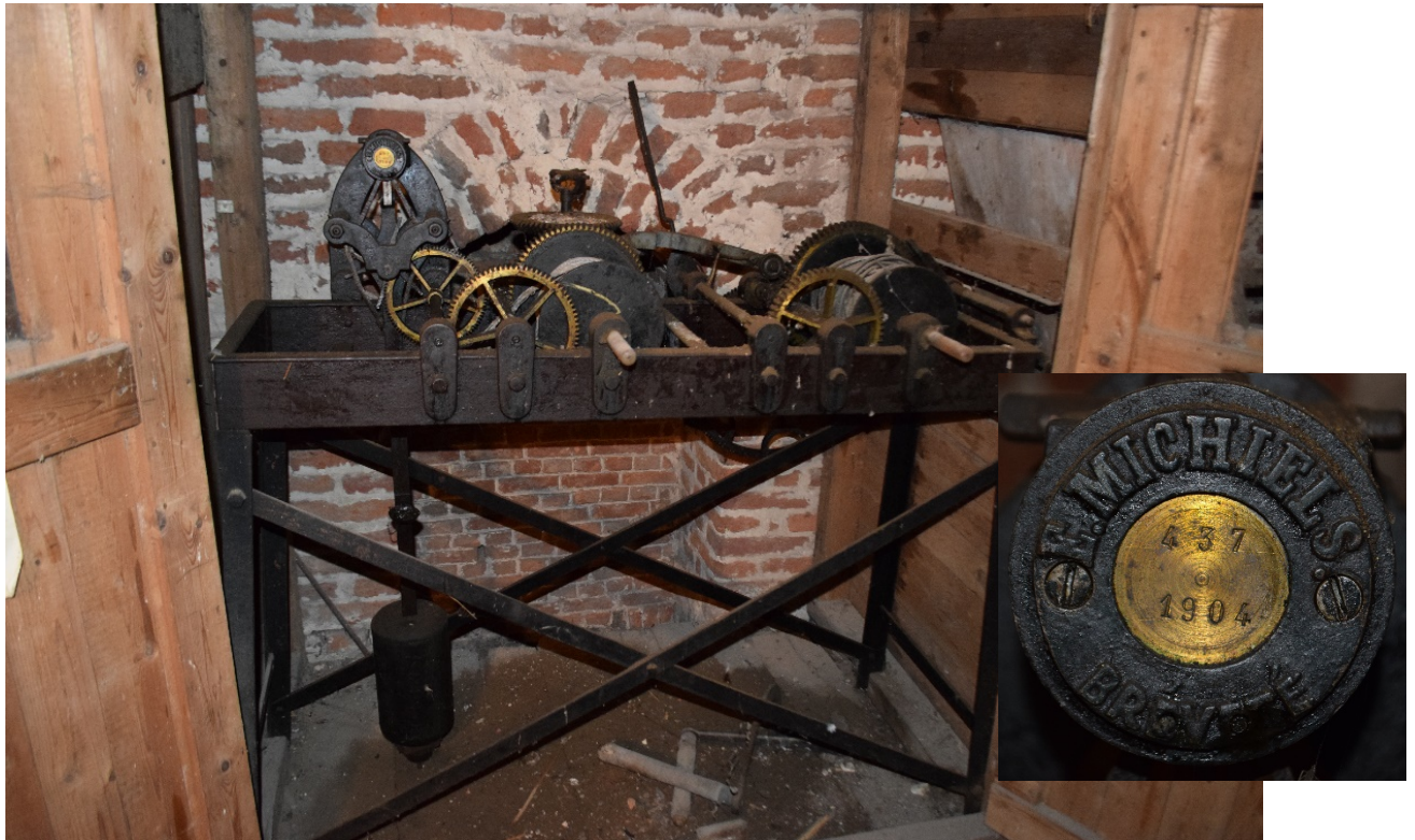
Fig. 69 en 69bis. Elektrisch aangedreven torenuurwerk van Edward Michiels (Mechelen) uit 1904
