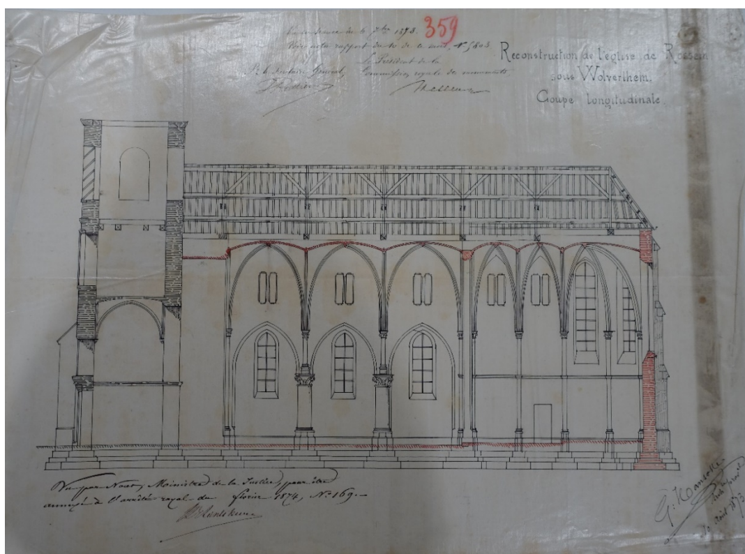
Afb. 37 Plan met langsdoorsnede van de kerk van architect Gustave Hansotte uit 1873 (Onroerend erfgoed, archief KCML Brussel)
