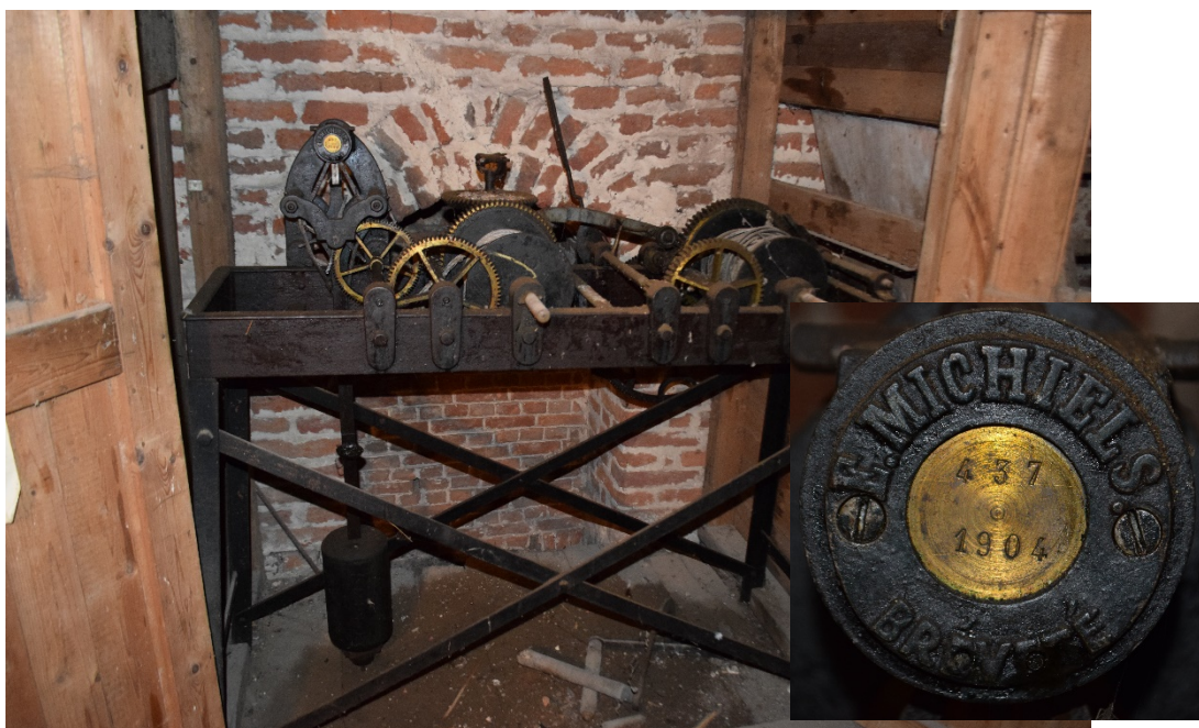
Afb. 67 Elektrisch aangedreven torenuurwerk van Edward Michiels (Mechelen) uit 1904
