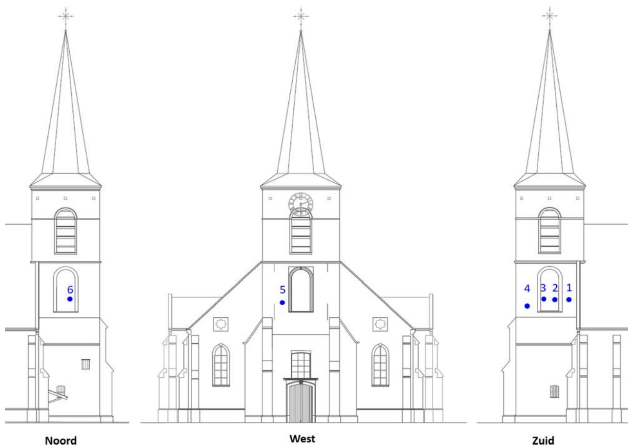
Fig. 18 Aanzichten torengesels met schematisch aanduiding locatie uitgevoerd endoscopisch onderzoek (uitgevoerd via binnenzijde van de toren t.h.v. niveau +3)
