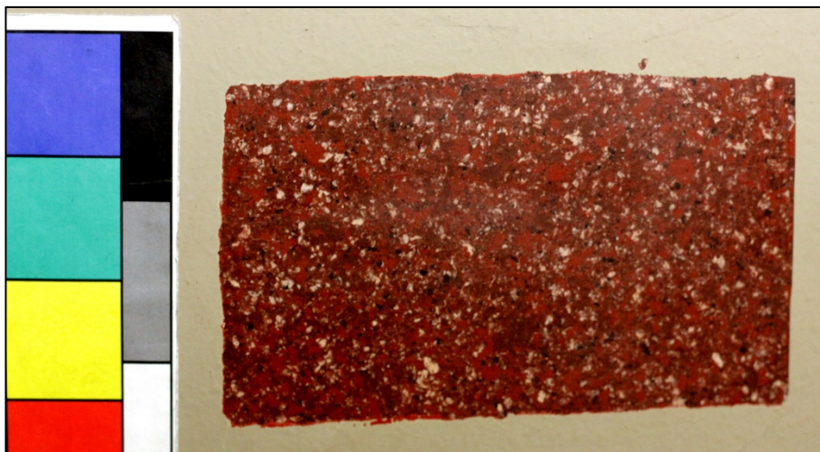
Figuur 16: De Glasal-plaat met spikkel.
