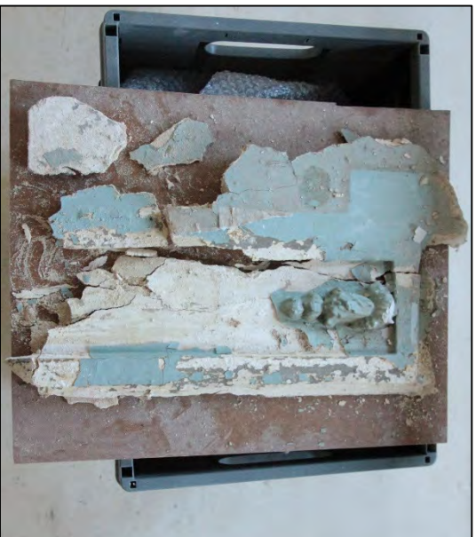
FIGUUR 34: RESTANTEN VAN DE ORNAMENTIEK VAN DE SCHOUW, BOVENSTUK ZIJPANEEL.
