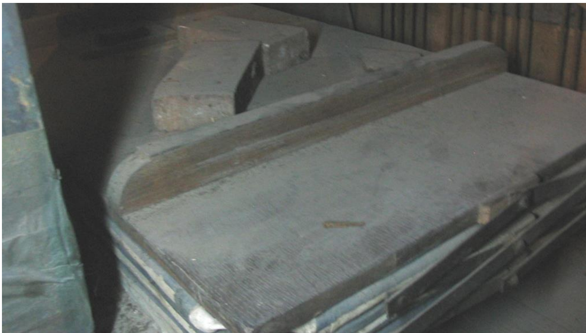
Situering: Veldwezelt I Sint Lambertuskerk. Beschrijving: Foto 140 | Orgel | In de onderkas bevindt zich een grote schokbalg, met eiken bovenblad. Bron: Orgelkundige Dick Zweers I 2008.
