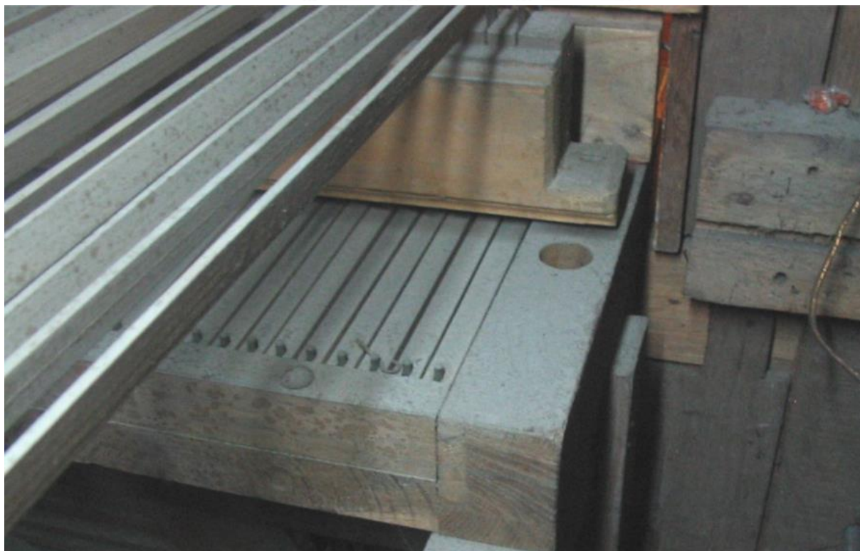
Situering: Veldwezelt I Sint Lambertuskerk. Beschrijving: Foto 145 I Orgel I Toetstracuur met winkelhaken boven het manuaal. Bron: Orgeldeskundige Dick Zweers I 2008.
