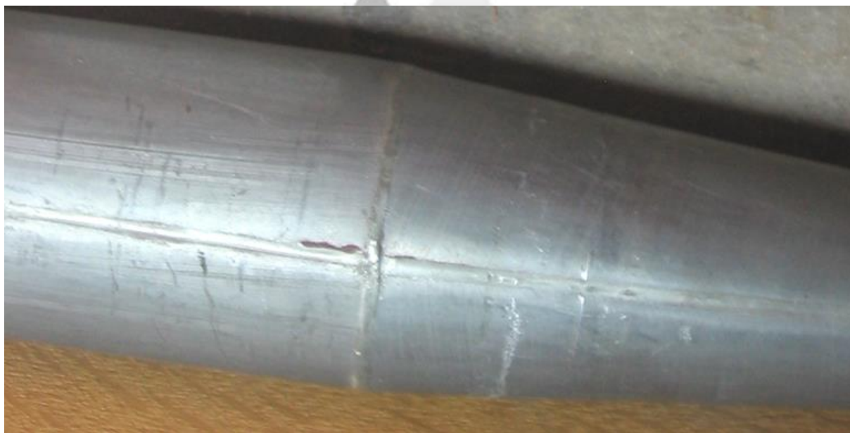
Situering: Veldwezelt I Sint Lambertuskerk. Beschrijving: Foto 127 I Orgel I Doublette 2', C-groot-pijp , soldeerkruis. Factuur Pereboom & Leijser. Bron: Orgeldeskundige Dick Zweers I 2008.
