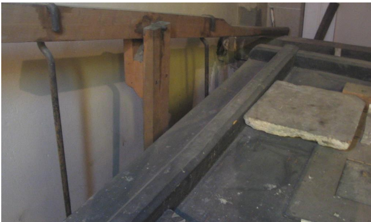
Situering: Veldwezelt I Sint Lambertuskerk. Beschrijving: Foto 138 | Orgel | Handbediening voor de twee schepbalgen. Bron: Orgeldeskundige Dick Zweers | 2008.
