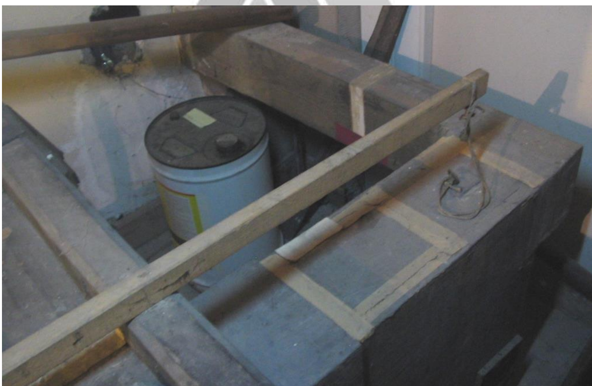
Situering: Veldwezelt I Sint Lambertuskerk. Beschrijving: Foto 139 | Orgel | Windkanaal van ventilator naar blaasbalg. Bron: Orgeldeskundige Dick Zweers | 2008.
