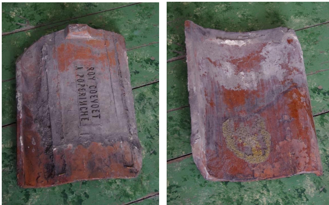
Figuur 167 - 168: Laat 19 de -eeuwse Vlaamse pan van Poperingse makelij met mechanische napersing (1881-1900). Door de stempelopdrukken kunnen de pannen nauwkeuriger gedateerd worden. Typevoorbeelden Poperingse productie.
