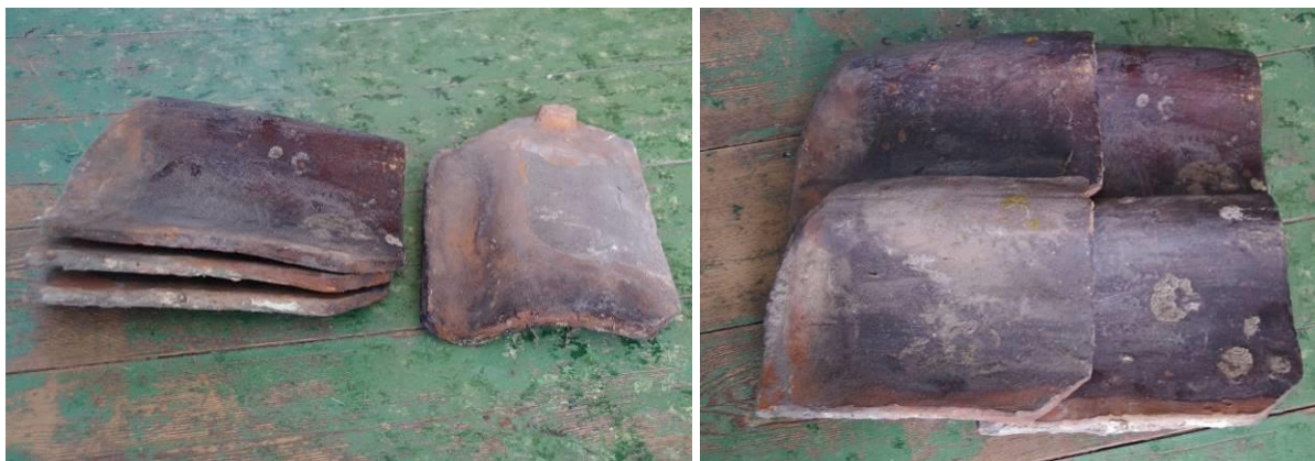
Figuur 165 - 166: Vlaamse pan van Poperingse makelij – oude 19 de -eeuwse handvorm. Typevoorbeelden Poperingse productie.
