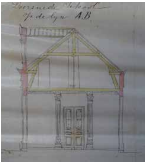
afb. 26: Detail: doorsnede inkomhal de nieuwe school door P.J. Taeymans, 1873 © Rijksarchief Beveren.
