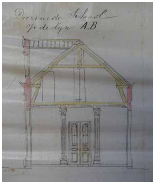
afb. 48: Detail doorsnede inkomhal, plan voor het bouwen van een nieuwe meisjesschool door P.J. Taeymans, 1873 © Rijksarchief.
