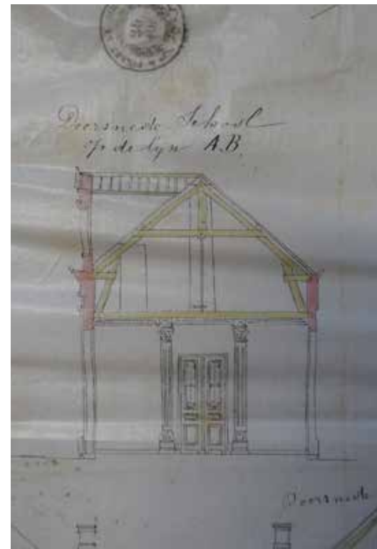
afb. 148: Doorsnede 2de deel, inkomhal met vestiaire, naar ontwerp van P.J. Taeymans, 1873 © Rijksarchief Beveren.
