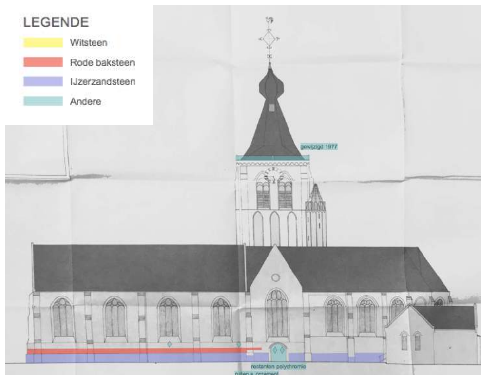
Afbeelding 110: Visuele weergave van de materialen van de zuidgevel
