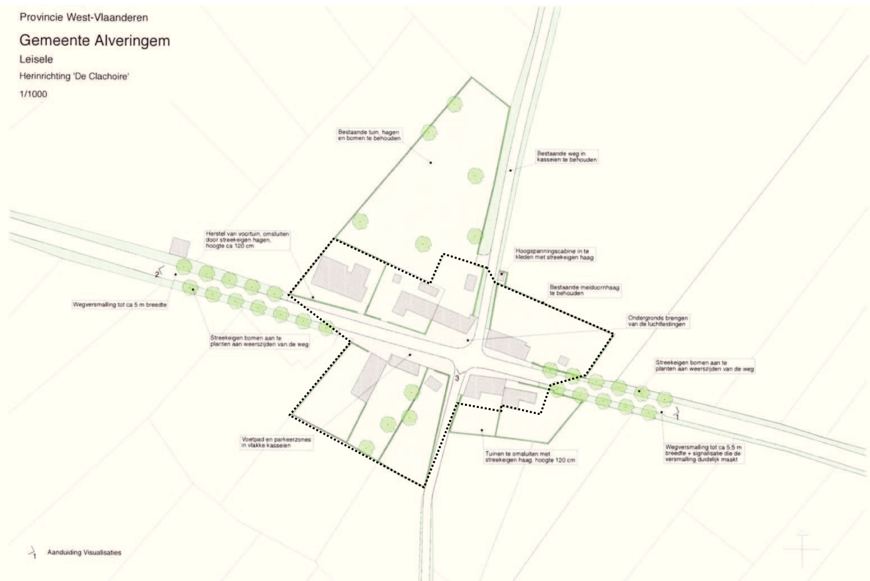
Fig. 8. Leisele, de Clachoire. Voorstellen inrichting openbaar domein en groenaanleg individuele percelen. De stippellijn is de omlijning van het dorpsgezicht.
